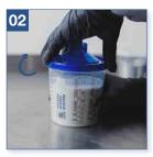
Coloque la tapa con filtro encima del vaso y gire un cuarto para bloquear
