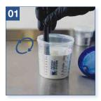
Mezclar la pintura directamente dentro del vaso **INDASA Mixing System**
