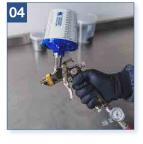
Desconectar línea de aire comprimido. De la vuelta a la pistola y tire del gatillo para liberar el exceso de pintura.
